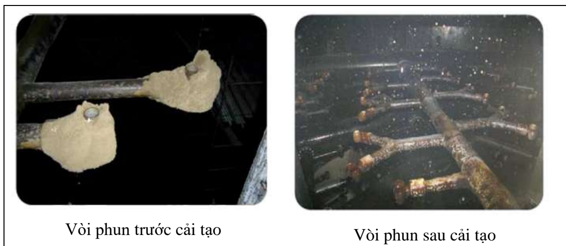
Hình 2.3.12: Cải tạo vòi phun tại nhà máy điện Iskenderu
